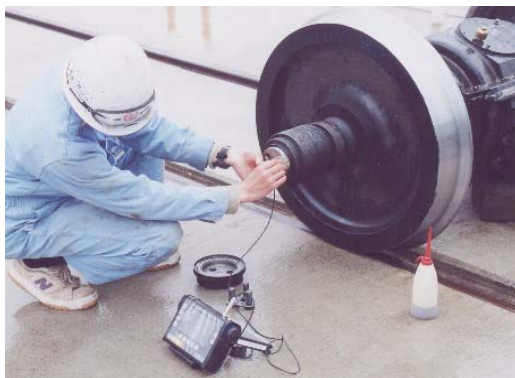
試験状況(垂直探傷)
