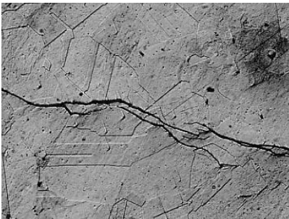
応力腐食割れ
