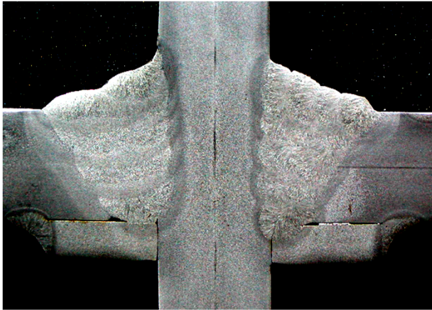
鋼板溶接部のマクロ試験
