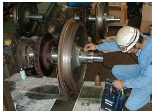
試験状況(斜角探傷)
