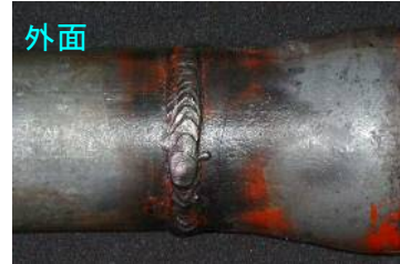
磁粉探傷試験状況
