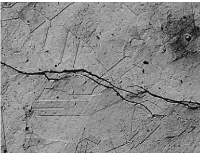
応力腐食割れ
